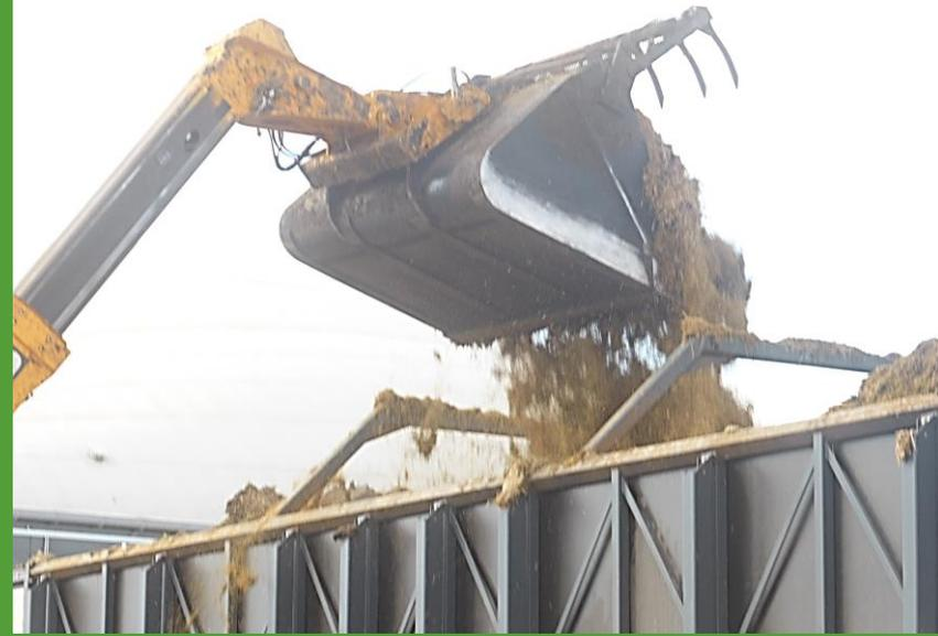
On met 30 tonnes par jour de matière dans la trémie. Puis tout au long d'une journée cette matière est injectée dans le digesteur. On rajoute du digestat liquide (30 tonnes par jour également) pour liquéfier l'ensilage et la paille.
