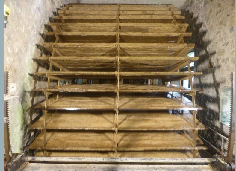
La cage de roue va utiliser la force motrice qui arrive par le canal d'amenée et repart par le canal de fuite.
