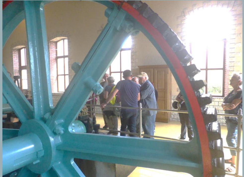
Par un savant jeu d'engrenages, la rotation de la roue à aube actionne les pompes à piston. Cela permet le relevage des eaux souterraines. La force motrice permet donc de déplacer de l'eau. Nous avons face à nous l'utilisation dès le XIX<sup>ème</sup> siècle d'une énergie renouvelable.
