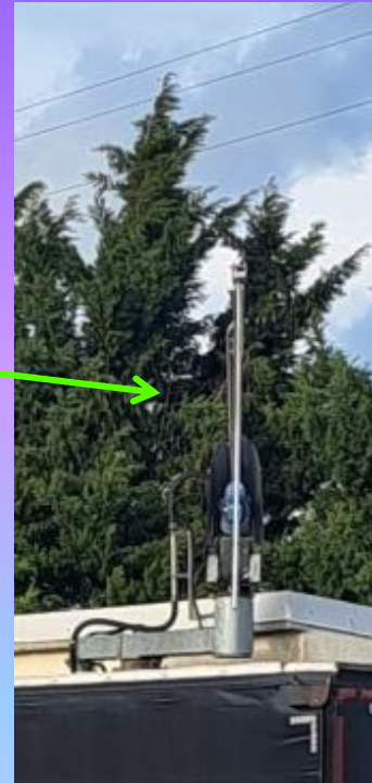
Sonde de prélèvement du grain : le héron.
